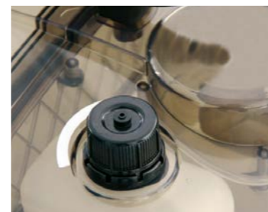
Un rezervor separat permite utilizarea agentului antispumant și garantează o muncă fără probleme.
